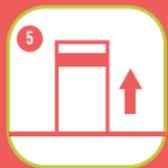
Les bornes remontent automatiquement après le passage du véhicule et certitude d'aucune présence sur la boucle de sécurité
