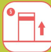
Les bornes remontent automatiquement après le passage du véhicule et certitude d'aucune présence sur la boucle de sécurité
