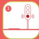
La fin de bornes basses est signalée par un passage au feu rouge clignotant puis au rouge fixe avant la remontée des bornes, après vérification de présence sur les boucles de détection
